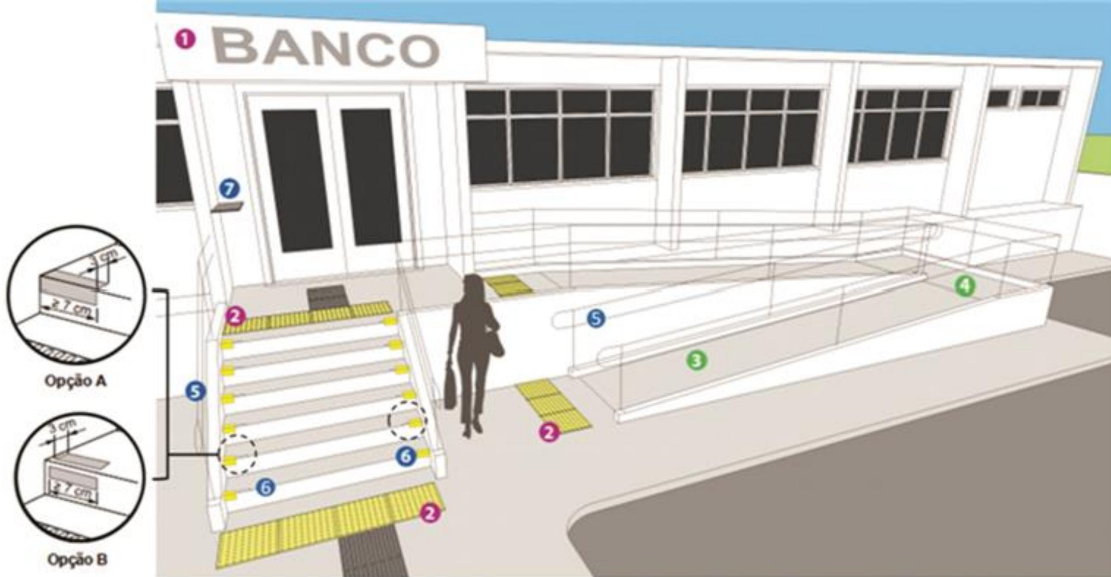
(1) letreiro com nome do edifício, (2) piso alerta indica a presença de desníveis (escada e rampa); quanto ao deslocamento - (3) rampa com inclinação máxima de 8,33% e largura mínima de 1,20 m, (4) patamar com dimensões iguais à largura da rampa; quanto ao uso - (5) corrimão em duas alturas: 70 e 92 cm, sem arestas vivas e nos dois lados da rampa e escada, (6) faixa em cor contrastante indica o fim de cada degrau, que não deve ser vazado, (7) suporte para o apoio de objetos.
