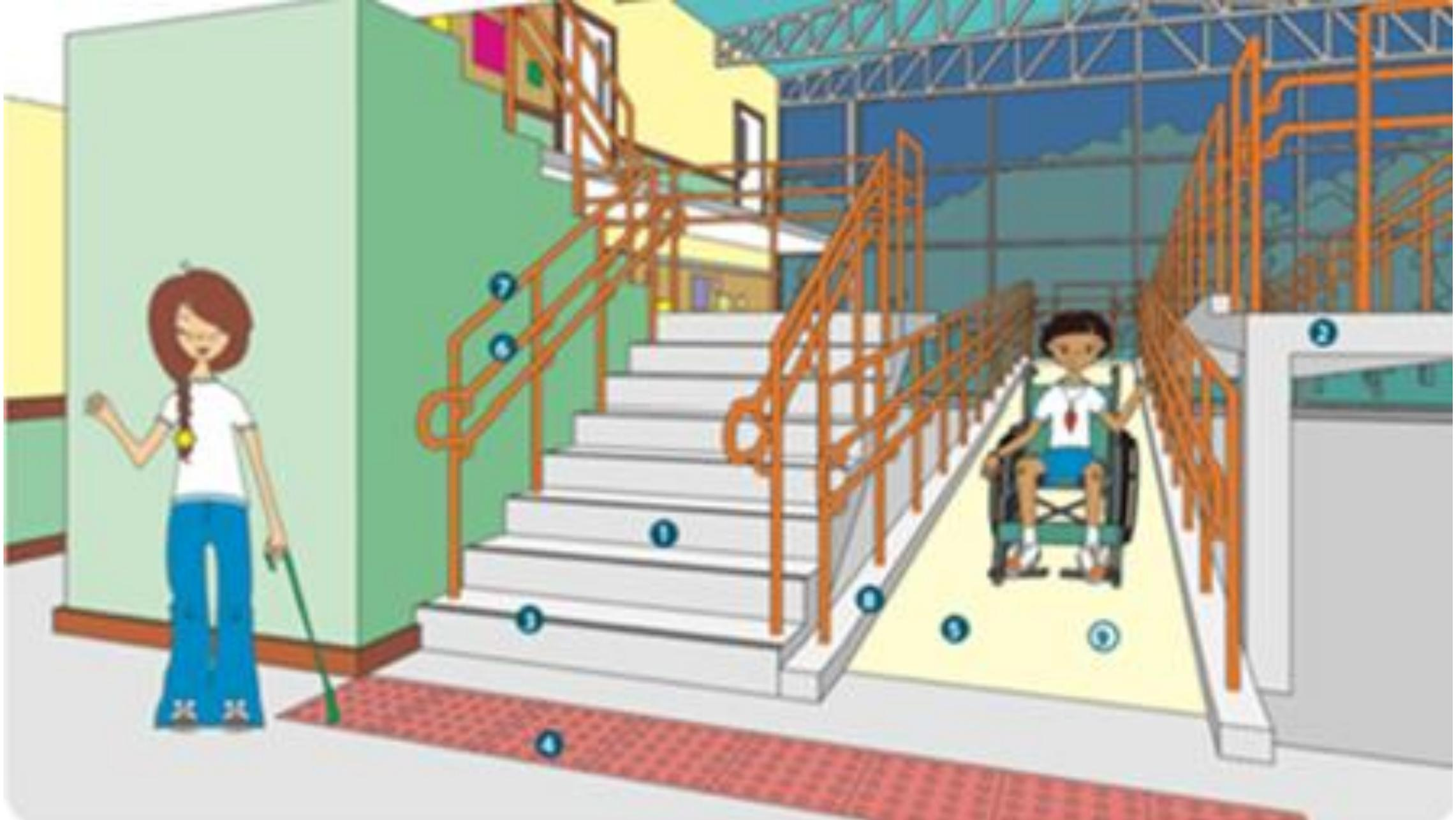
1) degraus sem espelho vazado; 2) rampa; 3) faixa contrastante no degrau; 4) piso tátil de alerta; 5 e 9) rampa com piso antiderrapante e inclinação adequada; 6) corrimão em duas alturas; 7) guarda-corpo; e 8) guia de balizamento.
